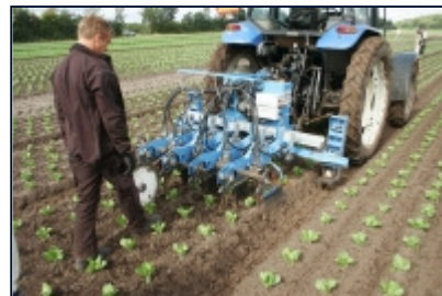
Lugerobotten bliver i første omgang fremstillet i en lille udgave, der dækker fem rækker på marken. Det er planen senere at lave en version til 15 rækker.
